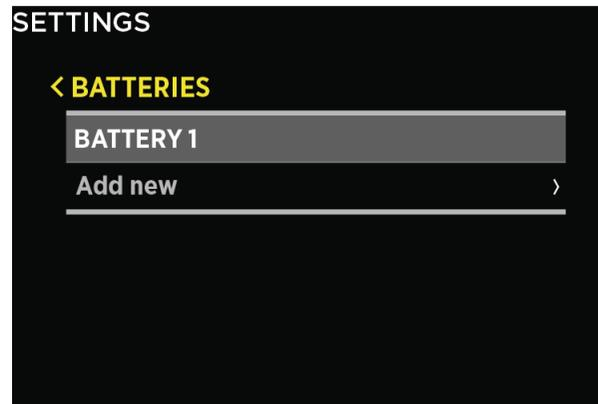
Wenn die Batterie nur mit einem Spannungssensor (ohne Stromsensor) verbunden ist, werden der Name der Batterie, der ungefähre Ladezustand (SOC) und die aktuelle Spannung angezeigt. Die Berechnung des SOC nimmt einige Zeit in Anspruch, so dass er möglicherweise nicht sofort nach dem Einschalten angezeigt wird.
